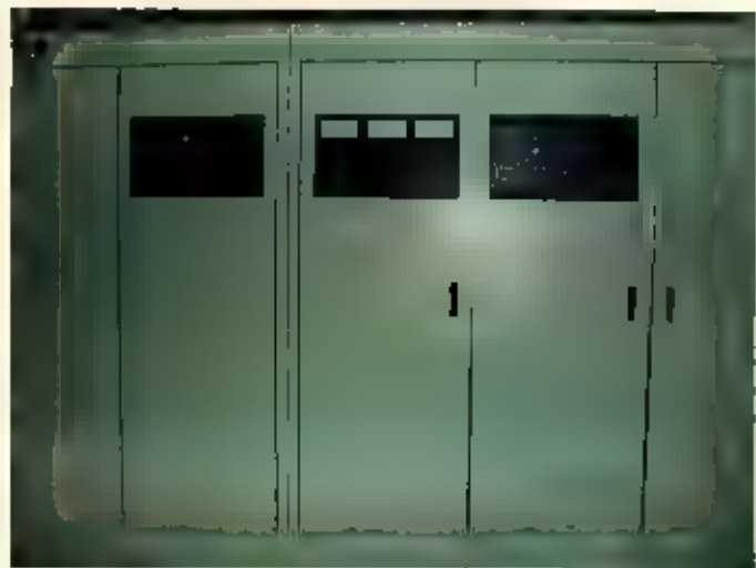
De nieuwe Harris-zender van 50 kW voor 1224 kHz, alleen halfgeleiders, dus geen buizen meer.
